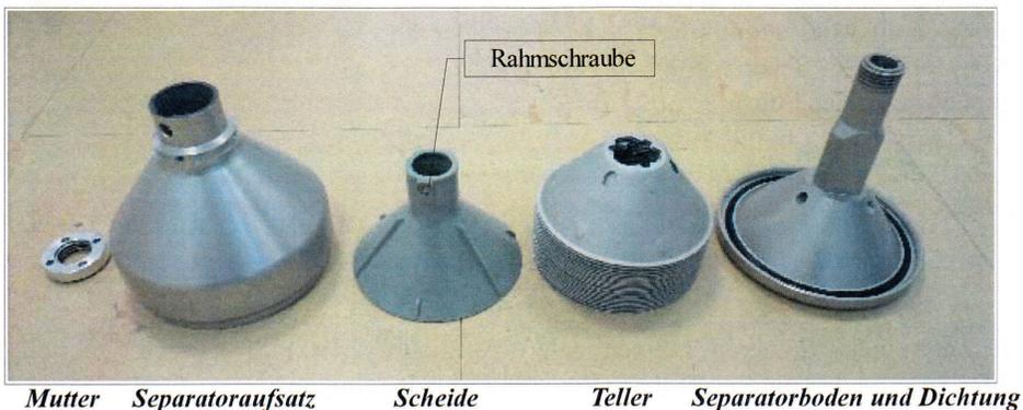
1/ Dichtung einlegen (am Separatorboden).
