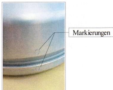
5/ Die Markierungen „0“ in dieser Stellung lassen, und die Separatormutter wieder von Hand eindrehen. Abschließend den Hakenschlüssel verwenden. Die Arretierung beenden, indem Sie dieses Mal den Separatorboden in der rechten Hand halten und den Schlüssel in der linken Hand und mit dem Schlüsselhinterteil mehrere Male kurz am Rand eines Tisches aufschlagen (siehe nachstehendes Foto).
