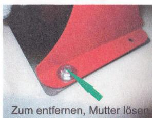
Zum entfernen, Mutter lösen
