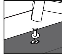
Nagel und Unterlegscheibe einschlagen bis sie gleichmäßig fest aufliegen und etwas versenkt sind
