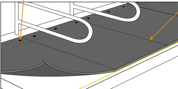
Puzzerverbindung bzw. Stoß in etwa unter dem Trennbügel (max. +/- 8 cm)
