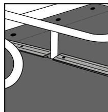
wenn nötig das KK-Profil teilen und einpassen ggf. **zusätzliche Fixierung(en)** in das Profil setzen
